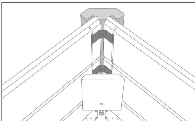
Osmo-система соединения углов (при помощи кламмеров).
