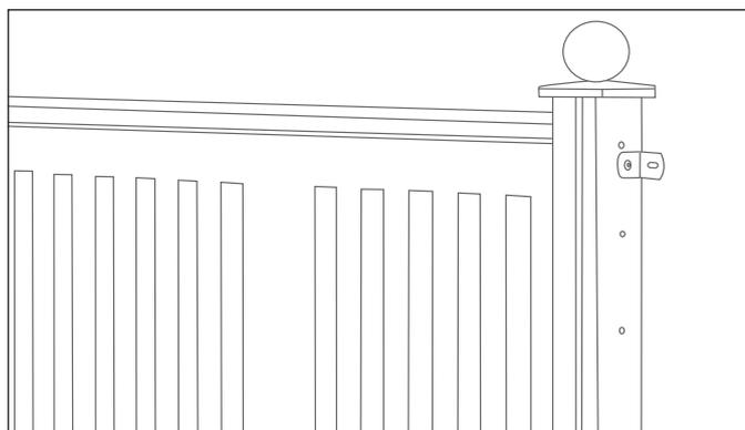
Крепеж секций заборов с рамной конструкцией
